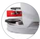
Щеточный узел и всасывающая балка из алюминия
